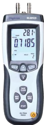
HLX8920 è un dispositivo che permette la lettura simultanea dei valori di pressione e di portata in modo semplice e veloce grazie al suo display LCD grande e retroilluminato. È possibile visualizzare i dati di misurazione con i loro valori massimi e minimi.
